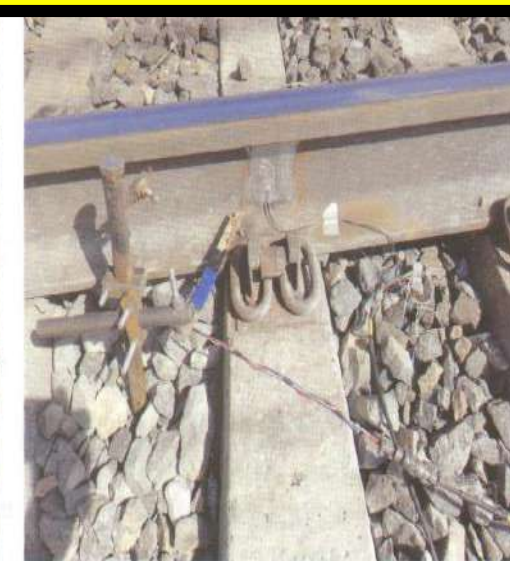
Рис. 2. Измерительные приборы, установленные для регистрации вертикальных сил и перемещений
