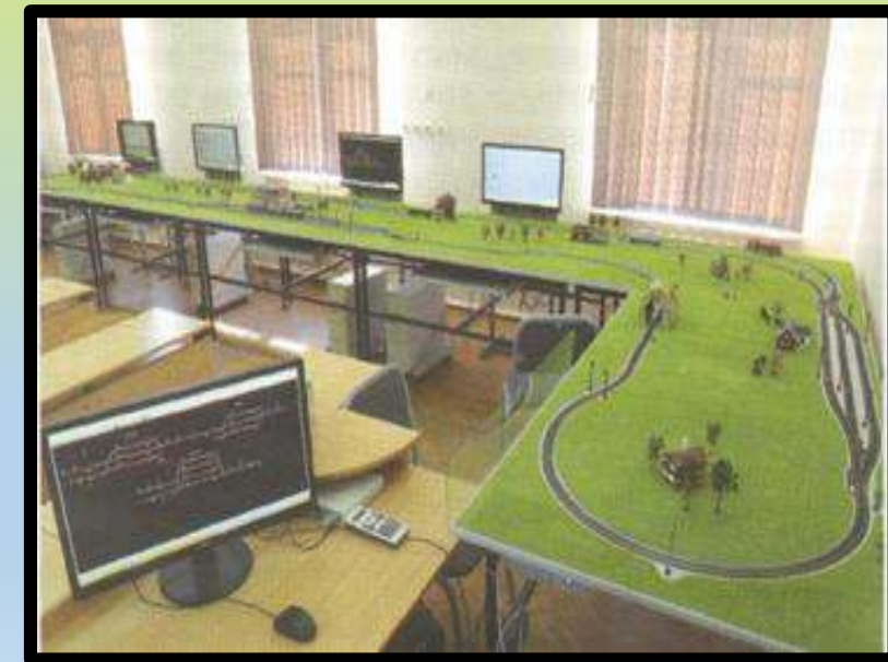
Аппаратно-программные тренажерные комплексы для изучения микропроцессорных систем управления движением поездов на участке железной дороги
