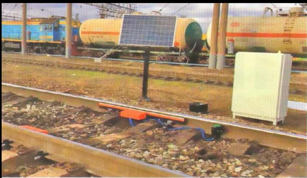
Рис. 3. Рельсосмазыватель типа РСЛ на станции Сызрань-1 Куйбышевской дороги
