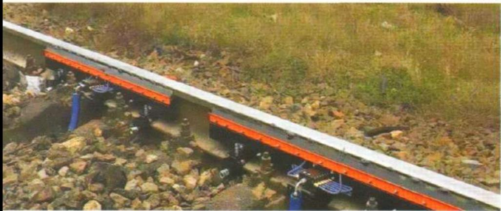
Рис. 4. Две питающие пластины с 24 каналами подачи смазки (станция Анисовка Приволжской дороги)
