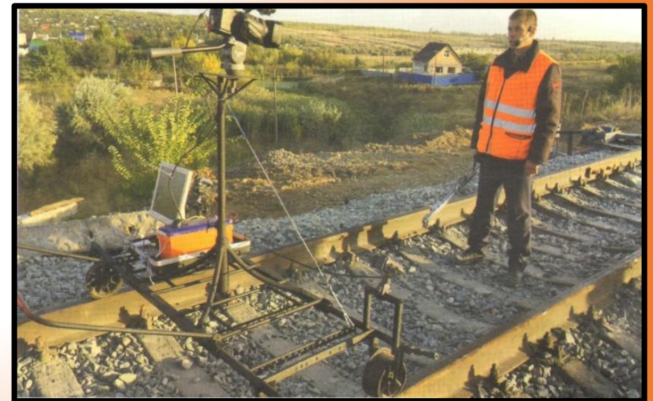
Дефектоскопная тележка с видеоборудованием
