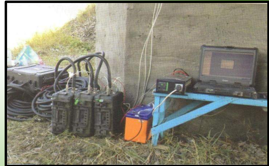
Мобильный виброизмерительный комплекс в рабочем состоянии
